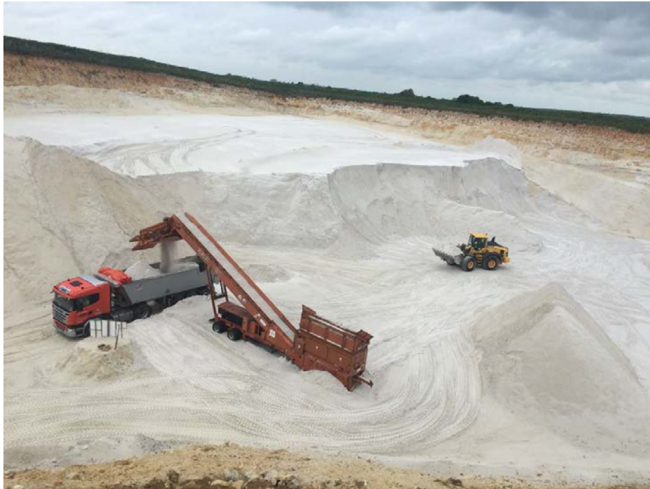
Criblage mobile et chargement des camions au carreau de la carrière
